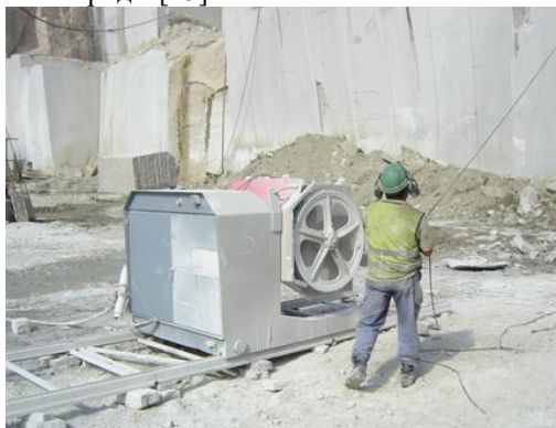
Рисунок 2 – Применение АКМ при добыче гранита на месторождении Rosa Porrino Испания алмазно-канатная машина фирмы Grani Roc
