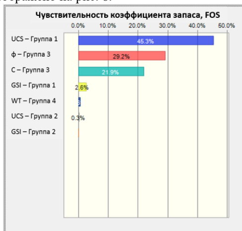
Рисунок 8 – Влияние геомеханических параметров в расчете коэффициента запаса устойчивости
