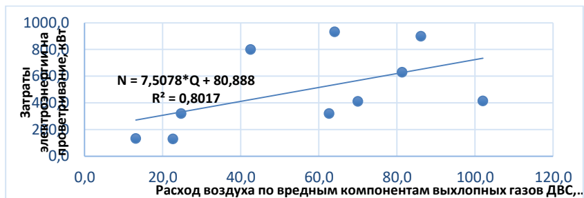
Рисунок 1 – Влияние расхода воздуха по фактору разжижения газов ДВС на энергетические затраты рудника
