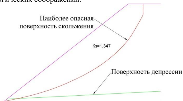
Рисунок 3 – Наиболее опасная поверхность скольжения в дамбе высотой 80 м при отвальной массе со сцеплением 0,04 МПа и углом внутреннего трения 35^\circ
