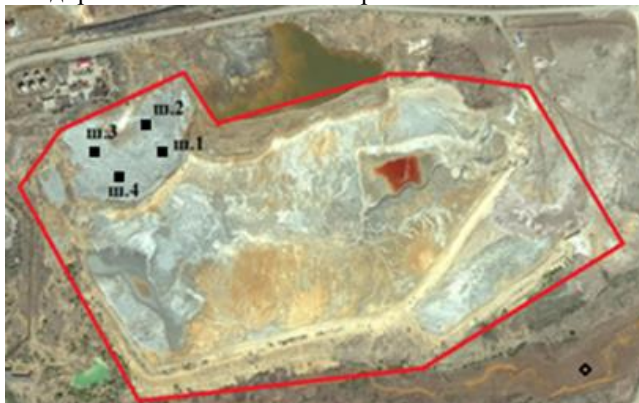
Рисунок 1 – План старогоднего хвостохранилища Сибайской обогатительной фабрики с нанесенным расположением пройденных разведочных выработок
