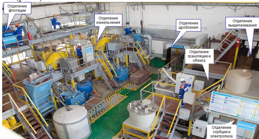
Рисунок 4 – Принцип проектирования горнотехнической системы «Шахта-завод», реализован в Республике Казахстан ТОО «Казгидромедь»
