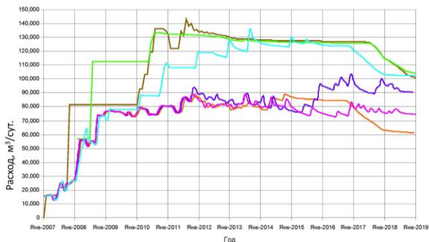
Рисунок 4 – Результаты моделирования режимов водоотведения на полный срок эксплуатации рудника
